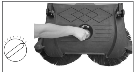
Рис. 7 Положение ручки регулятора высоты установки щеток
