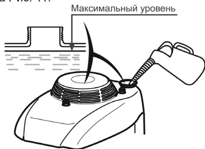
Рис. 11 Максимальный уровень топлива в топливном баке
