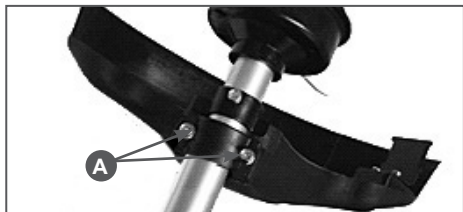
Рис. 2 Установка защитного кожуха
