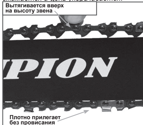
Рис. 7 Регулировка натяжения цепи
